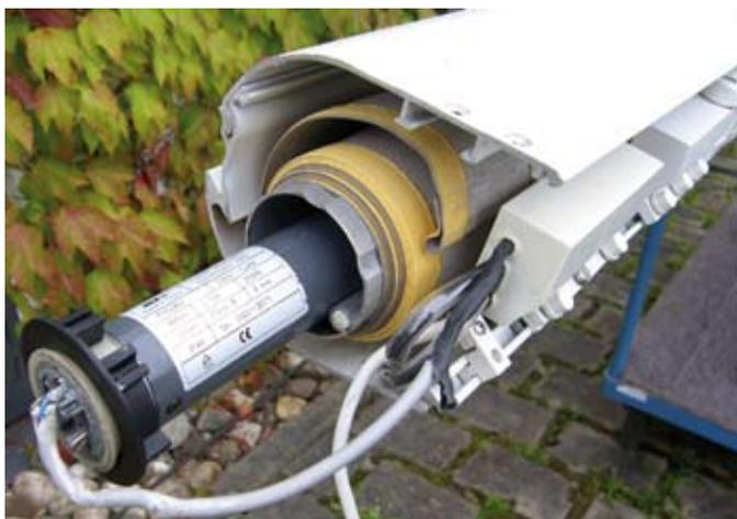
Deutlich zu erkennen sind die Verwindungen der Motorzuleitung durch unkontrolliertes Herausfahren der Markise und der Einbau der Steuerungselektronik im Feuchtigkeitsbereich der Markise. Die Herkunft des TÜV Zeichens auf dem Antriebsmotor konnte bisher nicht verifiziert werden. Das CE ist weit entfernt von den Anforderungen.
